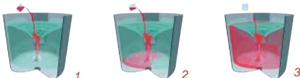
Afin de diminuer le vortex et d'éviter à l'installation de cavité, on conseille un montage excentré.
